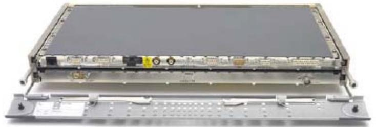
MINI-LINK HC представляет собой компактное решение для организации радиорелейных линий SDH со скоростью 155 Мбит/с (STM-1), работающее в полосах частот 7-38 ГГц. Данное решение предоставляет гибкие возможности по организации радиоканалов точка-точка с высокой пропускной способностью.
