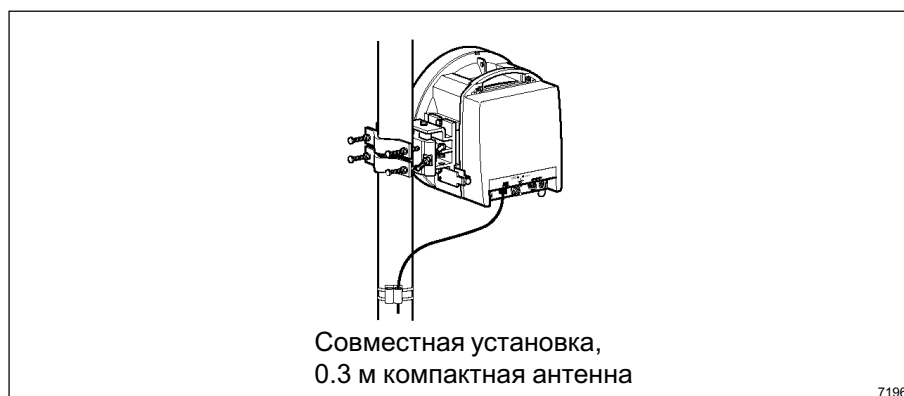
Рисунок 1-7. Нерезервируемый терминал, совместная установка
